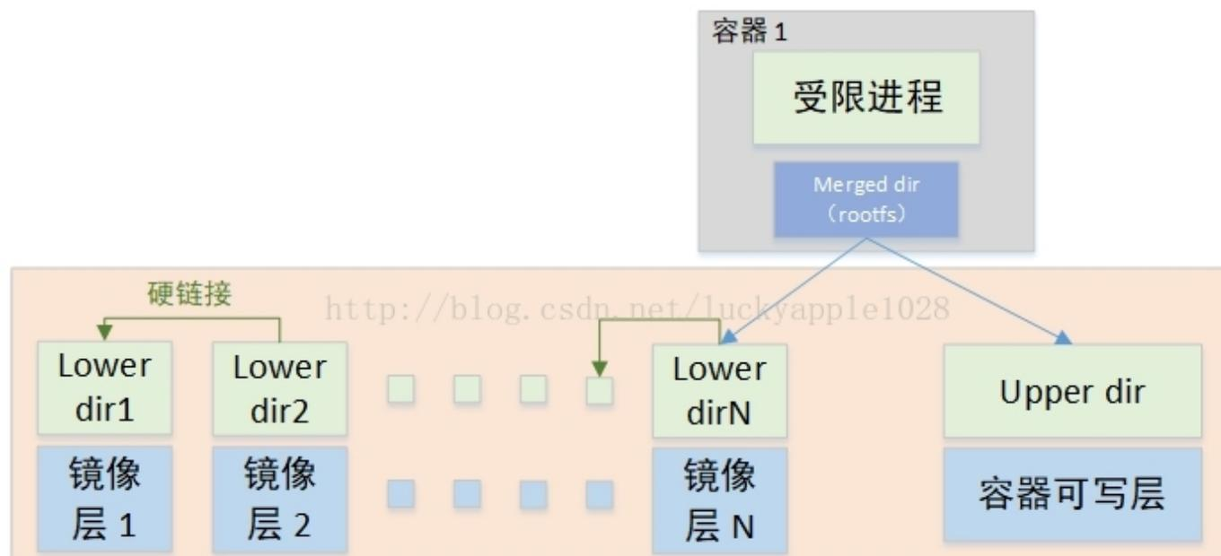
本图黄色框中的部分是镜像层和容器层的组织方式，各个镜像层中，每下一层中的文件以硬链接的方式出现在它的上一层中，以此类推，最终挂载overlayfs的lower dir为最上层镜像层目录image layer N。与此同时，容器的writable dir作为upper dir，挂载成为容器的rootfs。本图中虽然只描述了一个容器的挂载方式，但是其他容器也类似，镜像层lower dir N共享，只是各个容器的upper dir不同而已。
