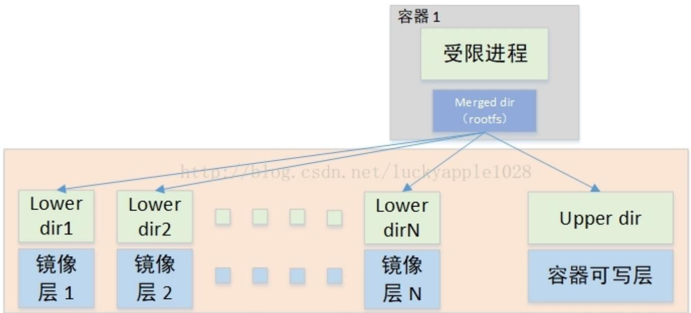
Overlay2的挂载方式比Overlay的要简单许多，它基于内核overlayfs的Multiple lower layers特性实现，不在需要硬链接，直接将镜像层的各个目录设置为overlayfs的各个lower layer即可（Overlayfs最多支持500层lower dir），对比Overlay Driver将减少inode的使用。
